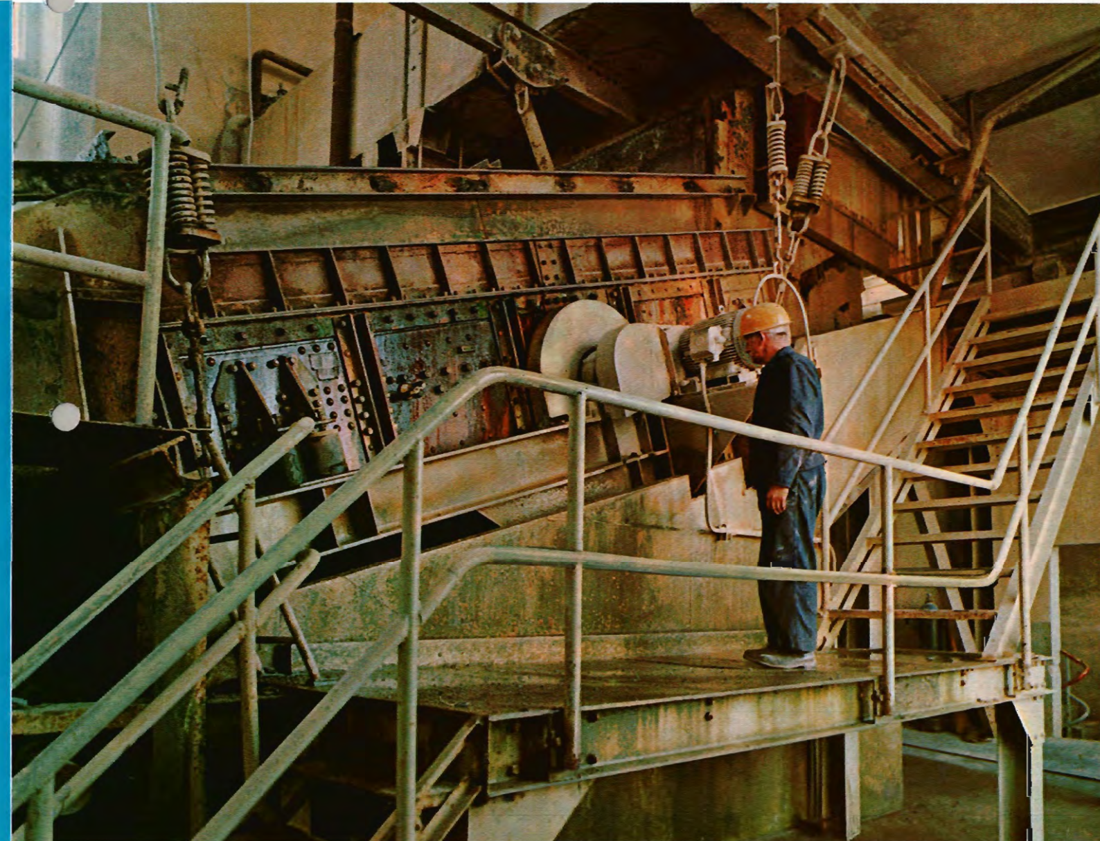
NIAGARA-Vorabscheider in schwerster Ausführung, Type ESS 2000 x 6000, beaufschlagt mit 2000 t/h Kalkstein zur Abscheidung von Material größer als 250 mm.
