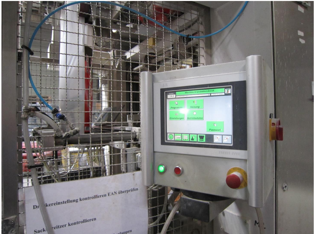
Eingabe Touchsreen für Sackgrößen, Geschwindigkeit, Schweißdauer
