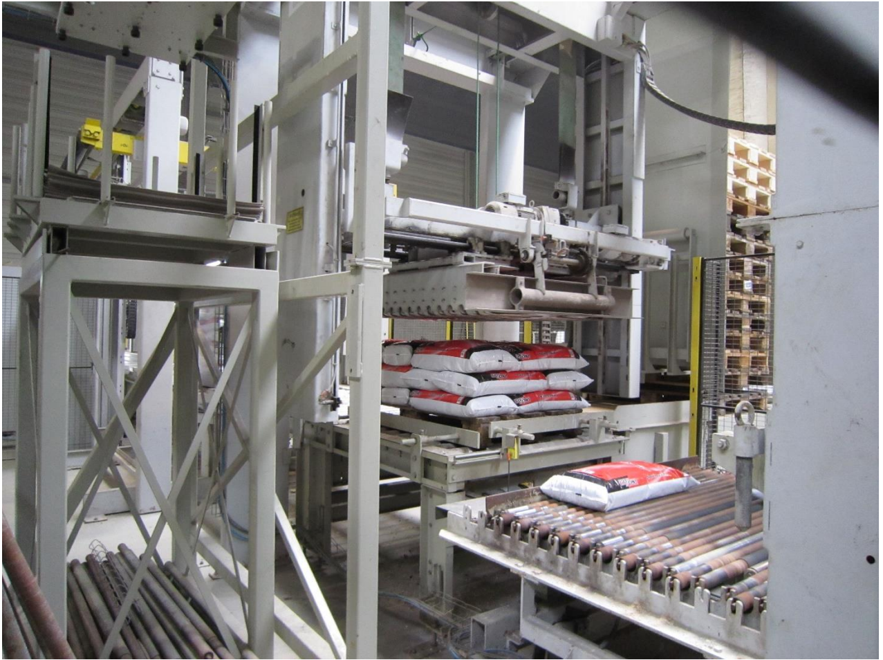
Wiko-Piehler Palettierer mit Deckblattaufleger, Europaletten aber auch Düsseldorfer Paletten Format
